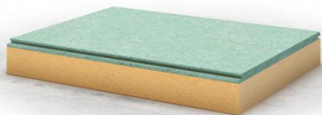
Укладка на пенополистирол
