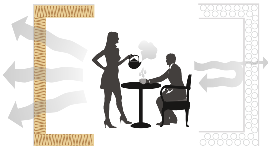
Рис. 1.3. Сравнение помещений, утепленных каменной ватой и пенопластом
